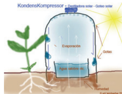
Figura 2. Izquierda, esquema de funcionamiento de un destilador solar
